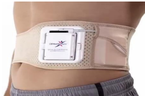
Figura 1. Sistema ottico C8 Medisensors, per il monitoraggio continuo della glicemia. Immagine adattata da http://www.nasdaq.com/article/labstyle-innovations-glucose-monitoring-for-the-mobile-age-cm246357
